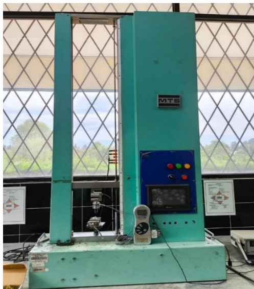
Figura 5. Máquina de ensayos universales MTS, Modelo T5002
