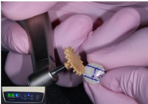
Imagen 13. Segundo paso sistema de pulido Ultradent
