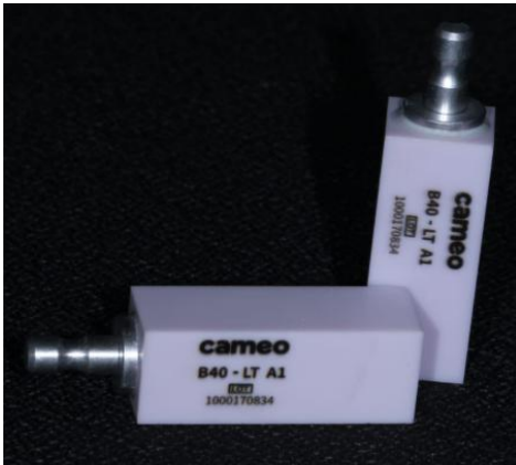
Imagen 1. Disilicato de litio Cameo B40
