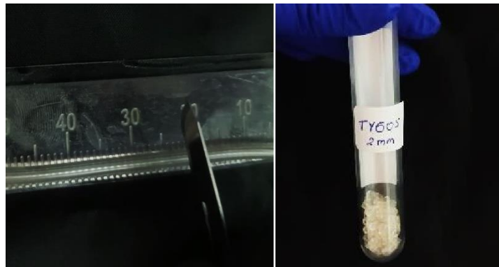
Imagen 1. Corte y almacenamiento de tubo Tygon
