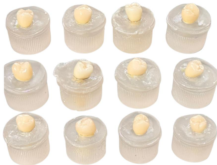
Figura 2 Conjunto de 12 coronas de disilicato de litio (Grupo A) finalizadas y montadas en resina, listas para el análisis experimental mediante CBCT.
