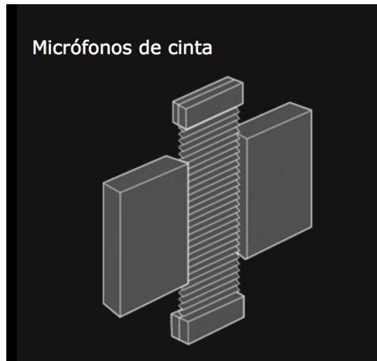
figura 2.2: Micrófono dinámico de cinta. Imagen tomada de (Shure, s. f.)
