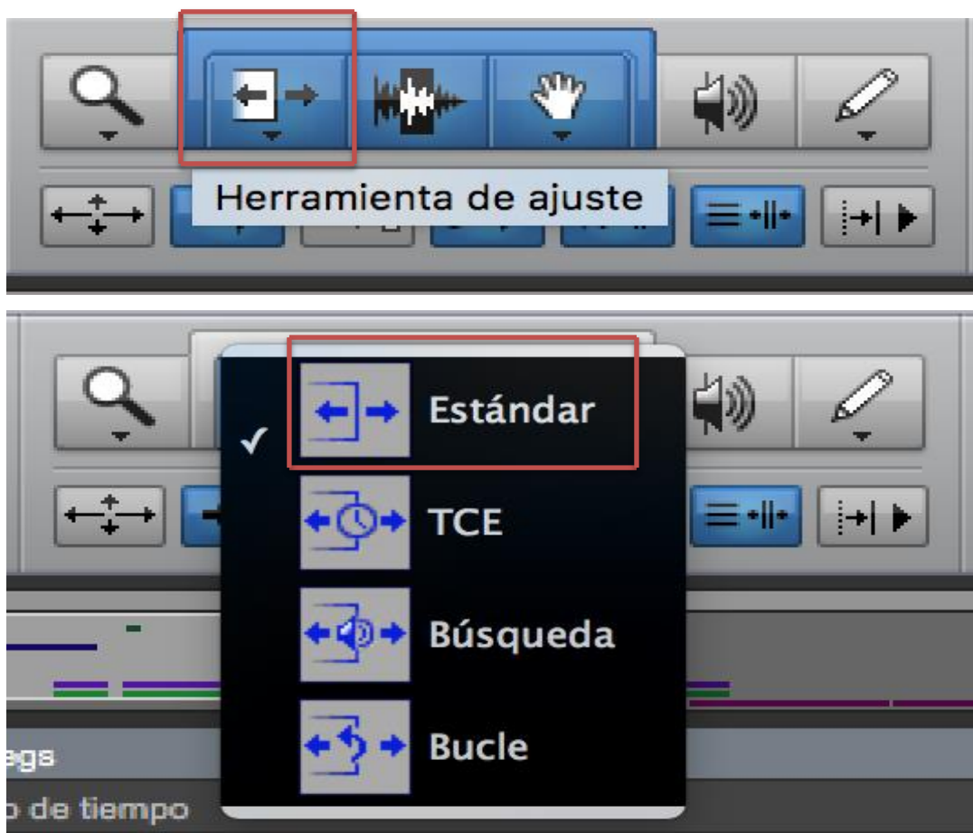
figura 3.31. En la parte superior se señala la Herramienta de ajuste. En la parte inferior se señala la opción Estándar de esta herramienta.
