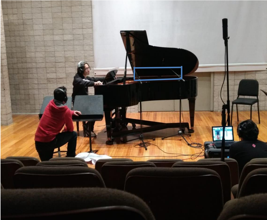
figura 3.20. Técnica variante de AB estéreo con micrófonos AKG C430.
