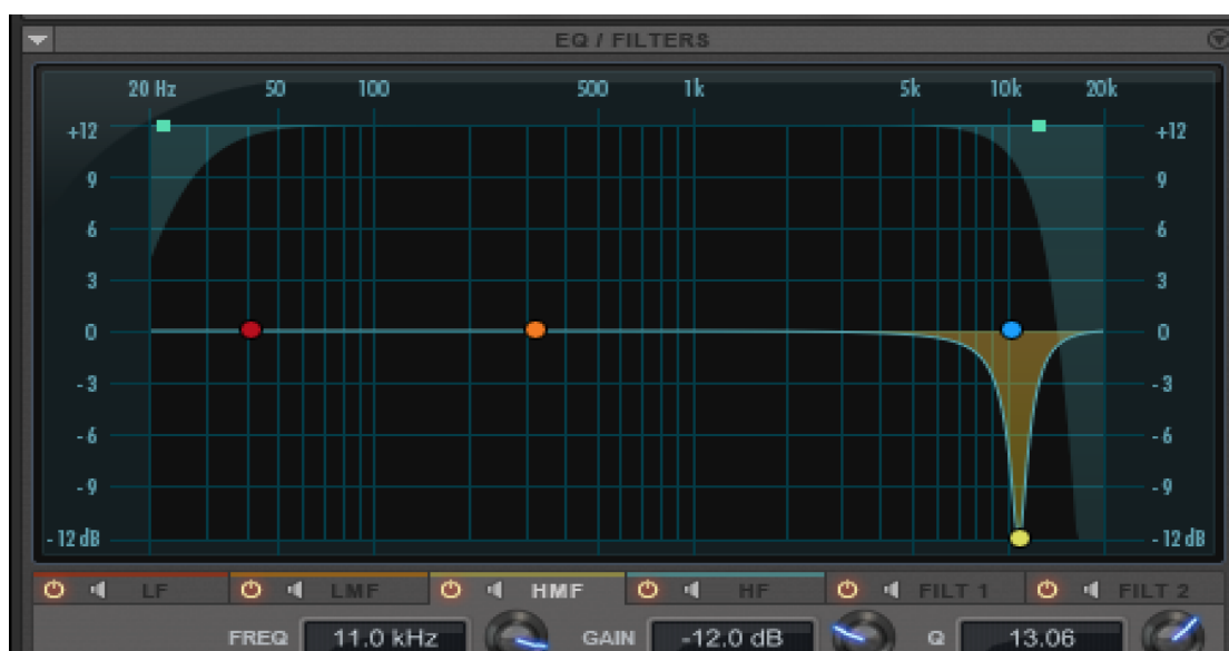
Figura 3.38. Barrido de frecuencias. Las frecuencias de 11.0 kHz se minimizaron hasta -12.0 dB, con una Q de filtro de 13.06
