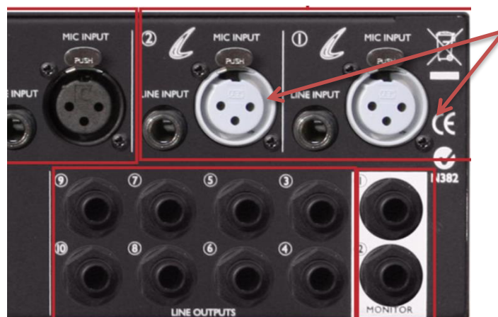
figura 3.14. Input 1-2 de la interface Focusrite liquid saffire 56. Las entradas señaladas son entradas XLR, canon, o entrada balanceada de micrófono de estas entradas. Imagen tomada de ( Liquid Saffire 56, Manual de usuario, s. f. )
