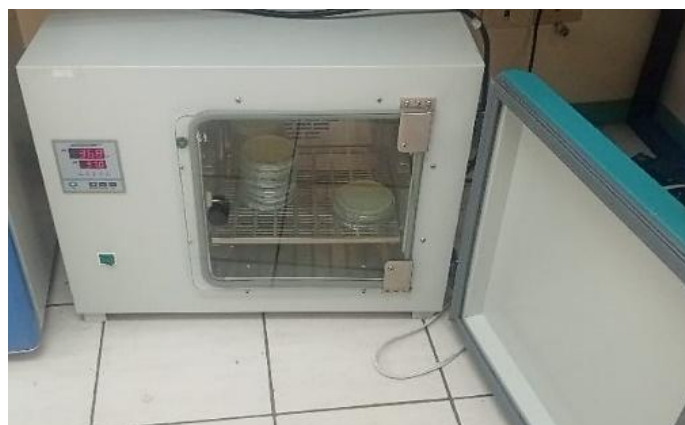
Figura 44 Cajas Petri en incubación a una temperatura de 37 °C
