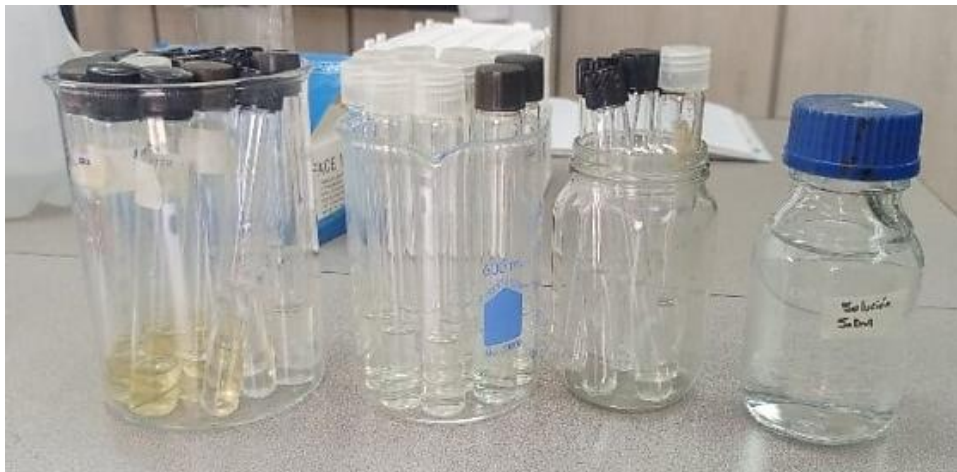
Figura 17 Colocación de los alambres en el caldo de BHI
