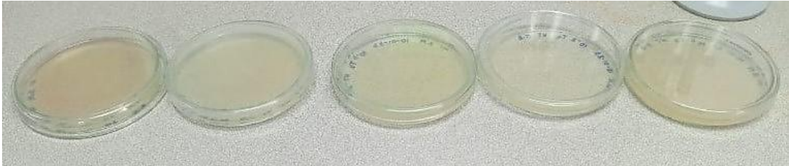
Figura 43 Cajas Petri con la Siembra del alambre de Niti
