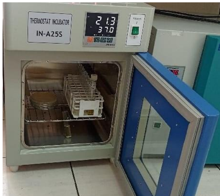
Figura 30 Tubos de ensayo con alambres de NITI y Acero con Streptococcus mutans
