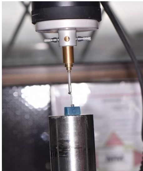
Figura 10 Resorte American Orthodontics comprimido con maquina Instron posterior a los 30 días del proceso experimental
