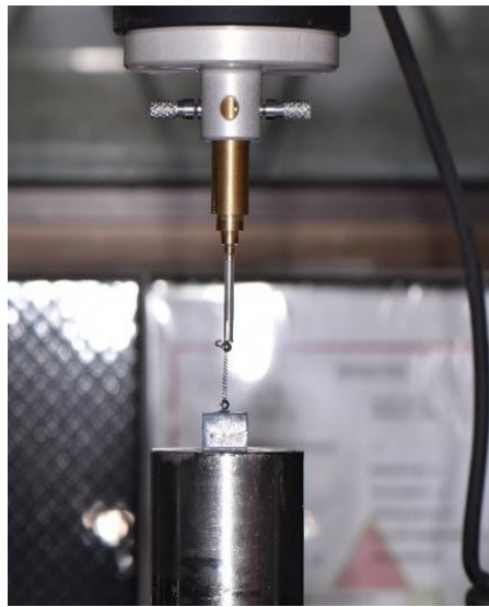
Figura 11 Resorte Ormco comprimido con maquina Instron posterior a los 30 días del proceso experimental
