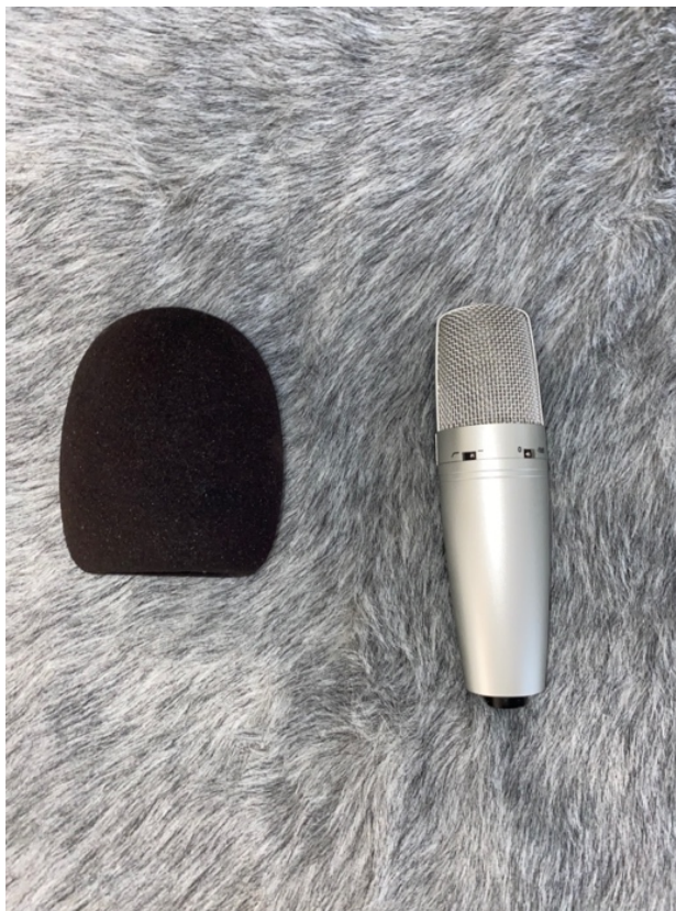
Ilustración 35. Micrófono de condensador (marca china) y capuchón.
