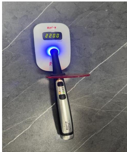
Figura 5. Verificación de la intensidad de luz.
