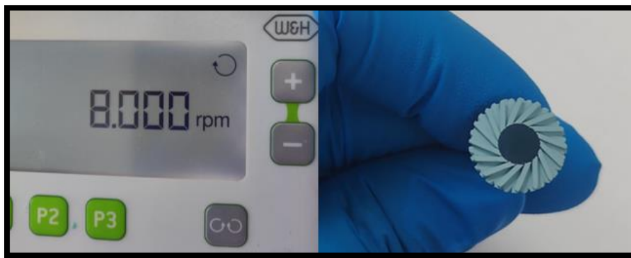
Figura 6. Pulido de las muestras con sistema Optragloss a 8.000 rpm
