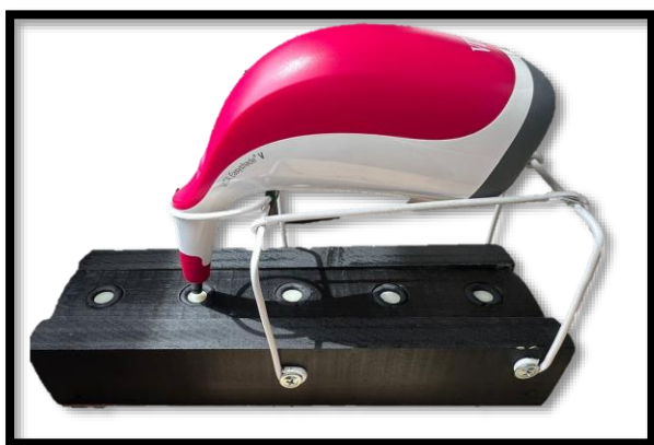
Figura 11. Soporte para estandarización de la toma de color
