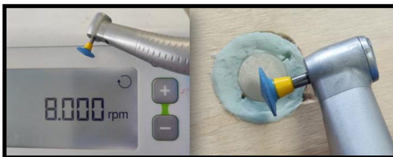
Figura 8. Pulido de las muestras con el sistema Eve a 8.000 rpm
