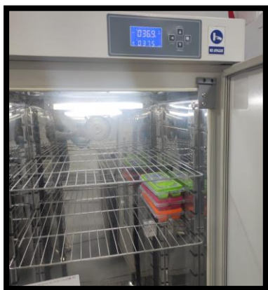
Figura 9. Muestras en recipientes sellados colocados en incubadora a 37°C
