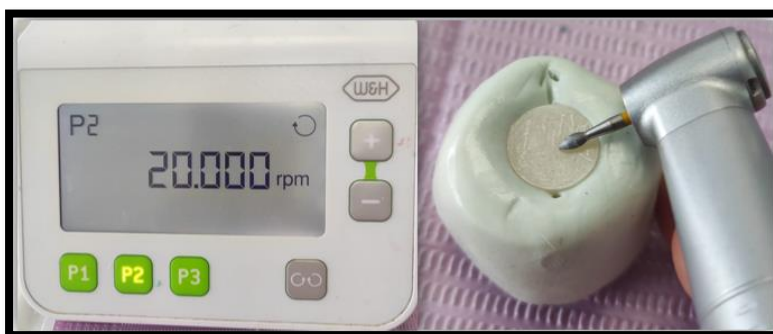
Figura 4. Ajuste inicial con fresa de diamante a 20.000 rpm
