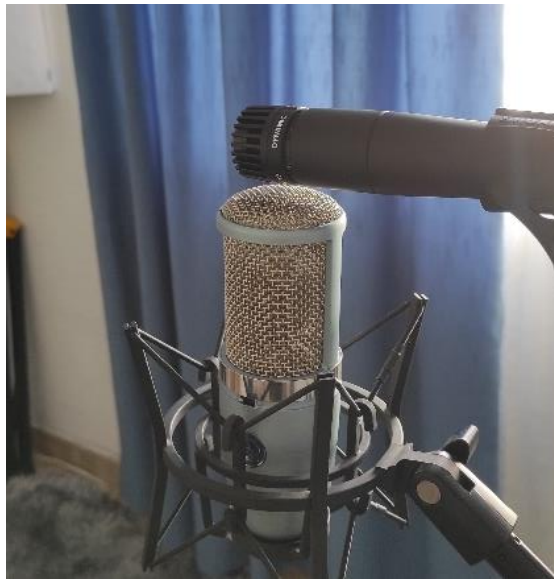
Ilustración 34 Técnica Mid-Side con un micrófono Akg P420 y Shure SM57
