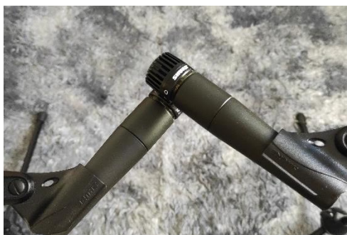
Ilustración 33 Técnica XY con dos micrófonos Shure SM57
