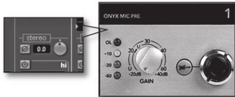
Ilustración 50 Secciones de entrada de una interfaz analógica
