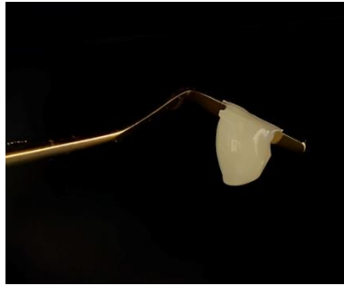
Fotografía. 7 y Fotografía. 8. Alteración en la viscosidad del compuesto resinoso al someterlo a una temperatura de 68°C por 10 minutos.
