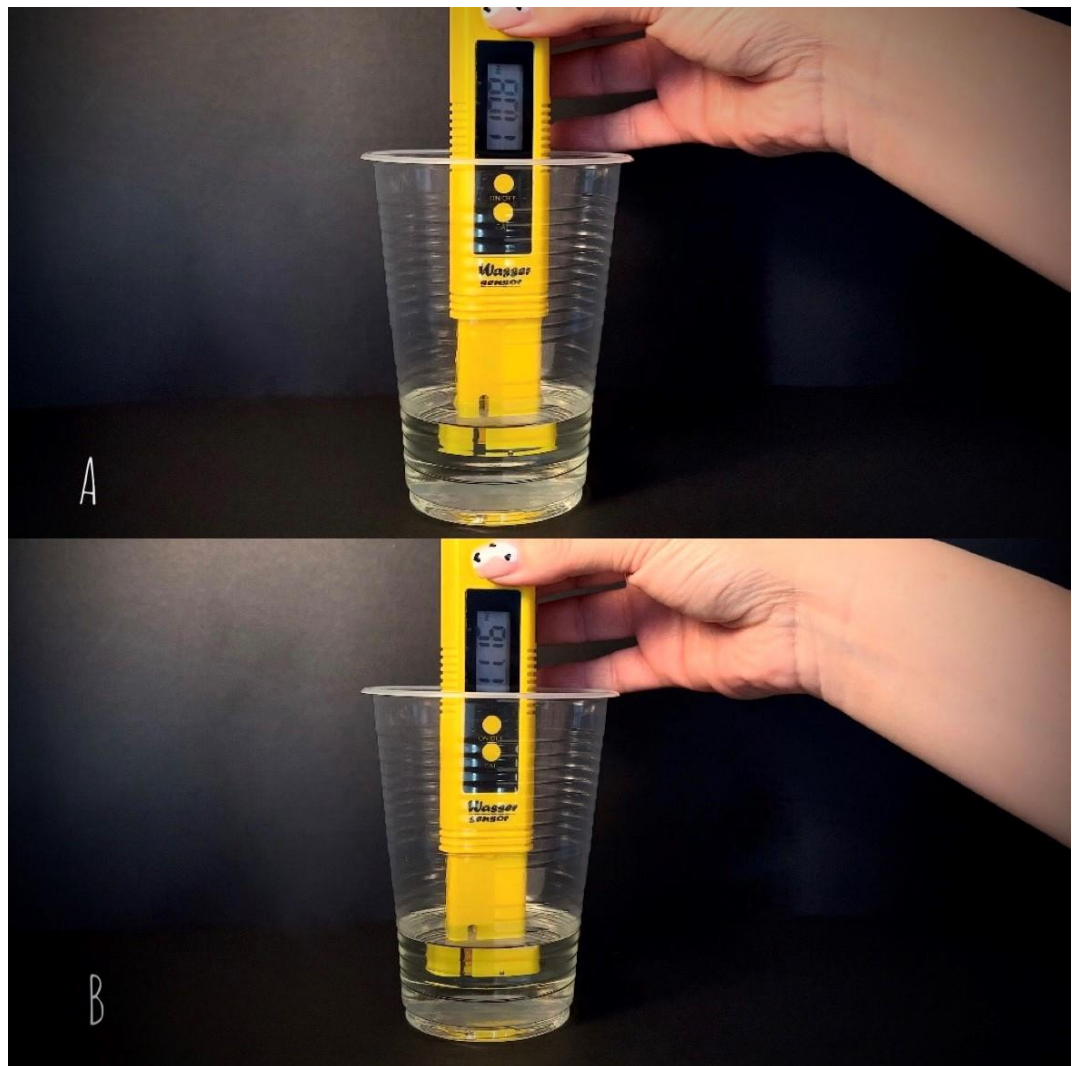
Figura 5. Medición del pH alcalino en cloro comercial de la marca “Clorox”, el mismo que presentó un valor de entre 11.08 (A) a 11.16 (B). Medido con un pH tester digital de la marca “Wasser sensor”.
